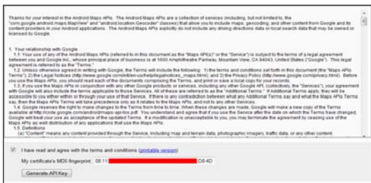
Fig.6: La chiave per l'utilizzo delle Google Maps API va richiesta online fornendo l'impronta MD5 del certificato che sarà usato per firmare l'applicazione Android
