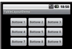
Fig. 18: Un TableLayout con nove bottoni disposti su tre righe e tre colonne
