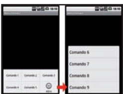
Fig. 9: Sono stati aggiunti nove comandi al menu. I primi cinque sono entrati a far parte dell'icon menu, mentre i restanti quattro sono stati posizionati nell'expanded menu dell'attività
