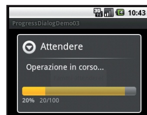
Fig. 11: Una ProgressDialog con barra di avanzamento secondaria
