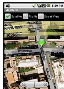
Fig.7: La posizione indicata dal ricevitore GPS viene evidenziata sulla mappa grazie ad una freccia disegnata in un overlay della mappa
