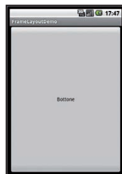
Fig. 15: Un bottone, inserito in un FrameLayout , viene espanso fino alla dimensione massima del layout
