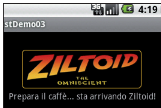
Fig. 2: Un toast di maggiore complessità, con icona e testo, costruito a partire da una definizione di layout esterna, in formato XML
