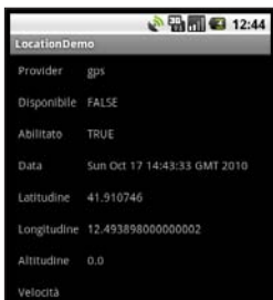
Fig.2: LocationDemo è un'app che si collega al ricevitore GPS e ne mostra le letture sul display
